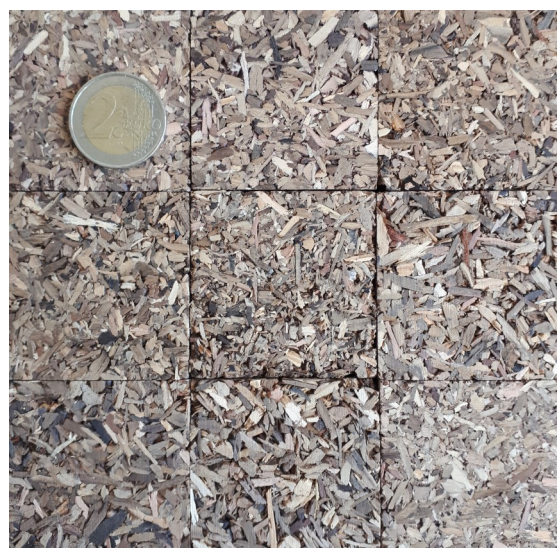
Abbildung 2: Spanplatten aus Kompost-Siebüberlauf (ohne Deckschicht).
